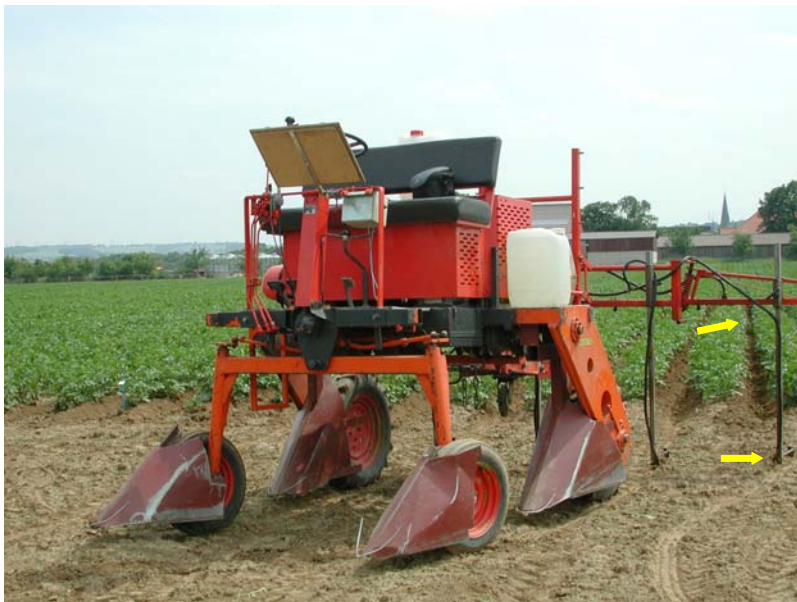
Bild 1: Feldversuchsspritze (Jacoby) mit Düsen zur Spritzung der Blattoberseite und Blattunterseite (gelbe Pfeile) im Anbau eines mit Krautteilern ausgerüsteten Hege - Versuchsschleppers.
