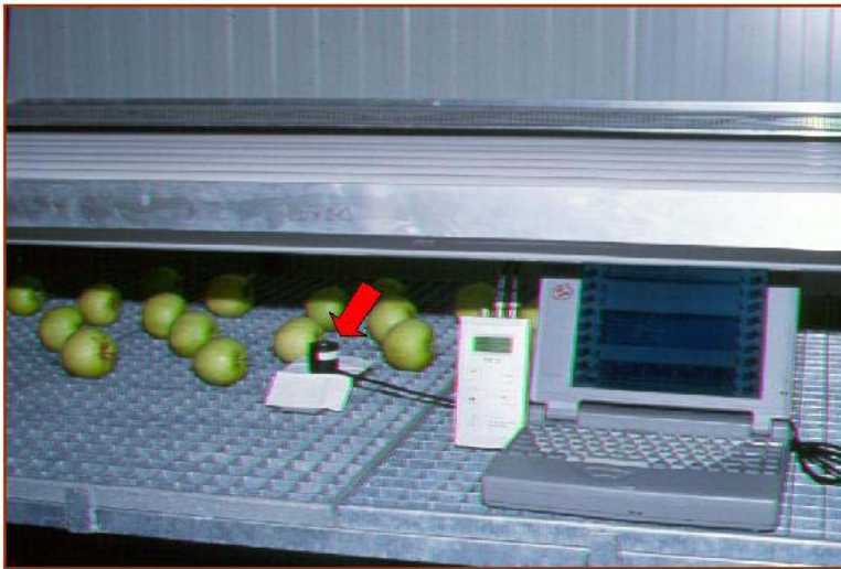
Klimakammer mit UV-B-Bestrahlungseinrichtung und UV-B-Sensor (Pfeil)
